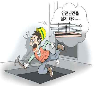
추락 위험구역에 안전난간 설치
