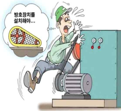
동력전달부, 회전체에 방호장치 설치
