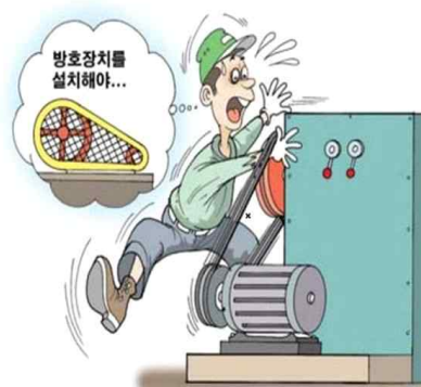
동력전달부, 회전체에 방호장치 설치
