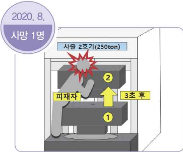
▶ 사출성형기 점검 중 내부 이동형판이 갑자기 상승하여 끼임
