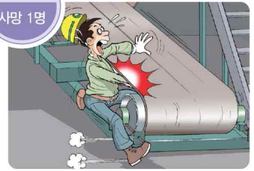
▶ 컨베이어 점검 중 끼임
