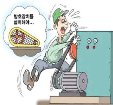
동력전달부, 회전체에 방호장치 설치
