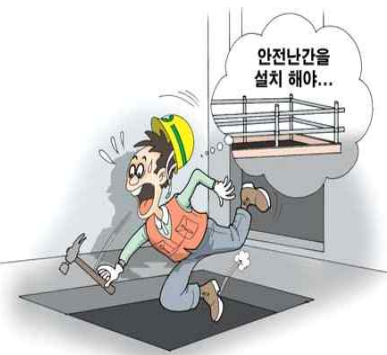
추락 위험구역에 안전난간 설치
