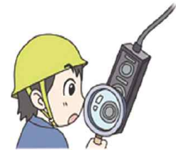
펜던트 스위치 및 무선 리모콘은 비상정지 장치의 정상작동 기능 유지와 방향표시 버튼의 훼손 유무를 점검하여 사용
